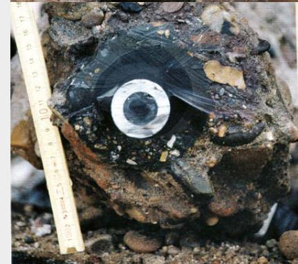
La barre d'armature avec son manchon de couplage est durablement protégée contre la corrosion. Dans certains cas particuliers, p. ex. si la barre est à nu, il peut être nécessaire d'avoir recours à des mesures supplémentaires telles que:
